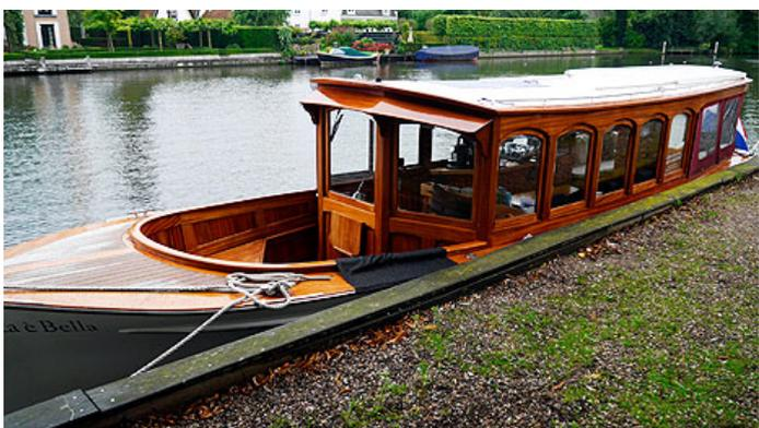
**Das 9,80 Meter lange und 2,85 Meter breite Holzboot mit seinem Dreizylinder Dieselmotor und seinen 13 Stundenkilometern fasst 12 Personen.**
